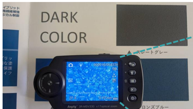
塗膜の顕微鏡観察（倍率27倍）
