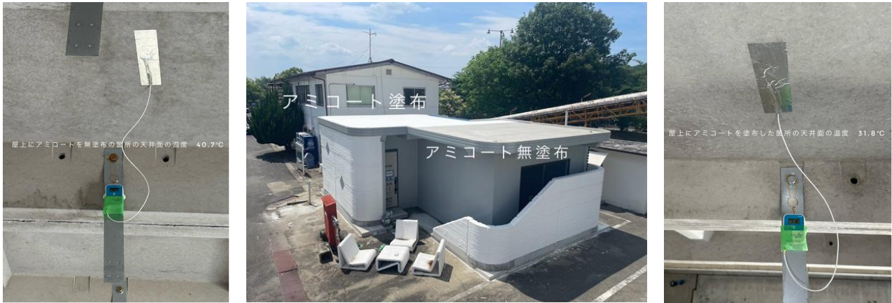
図 1．PC住宅における遮熱性能比較試験の計測状況
